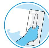
Proceda a la aplicación del producto con llana plana en una capa de 0,3 cm. de BunkerMax Over Coat sobre la superficie a trabajar.
