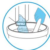
Dosifique el bulto de 20kg. de BunkerMax Over Coat hasta lograr una pasta homogénea y trabajable.
